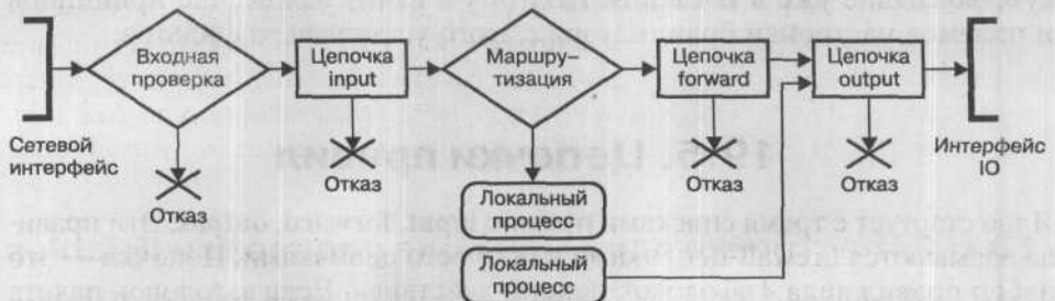
Рис. 19.1. Принцип работы пакетного фильтра
