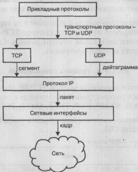
Рис. 27.1. Пересылка блока данных в стеке протоколов TCP/IP
